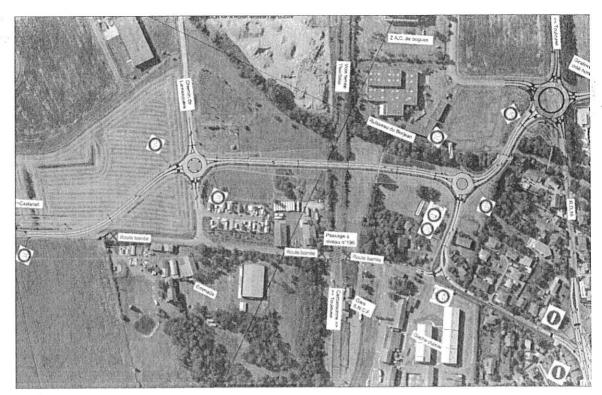
Le tracé entre le chemin de Lamasquère et la RD 16 franchit perpendiculairement la voie ferrée. Il est pratiquement rectiligne jusqu'au giratoire qui dessert la gare. Après franchissement du ruisseau du Berjean il se raccorde au giratoire du collège.
